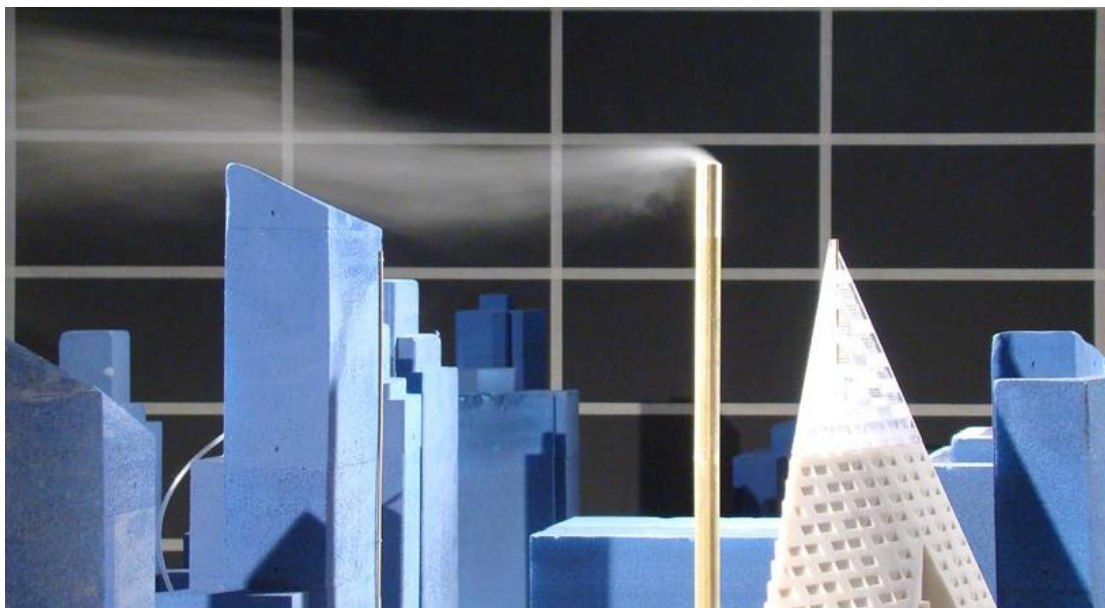
Rys.1 Symulacja przepływu w zabudowie miejskiej
