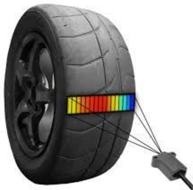
Rys.1 Czujniki temperatur - umożliwiają pomiar temperatury na całej szerokości opony, pozwala to na odpowiednie ustawienie jej pochylenia
