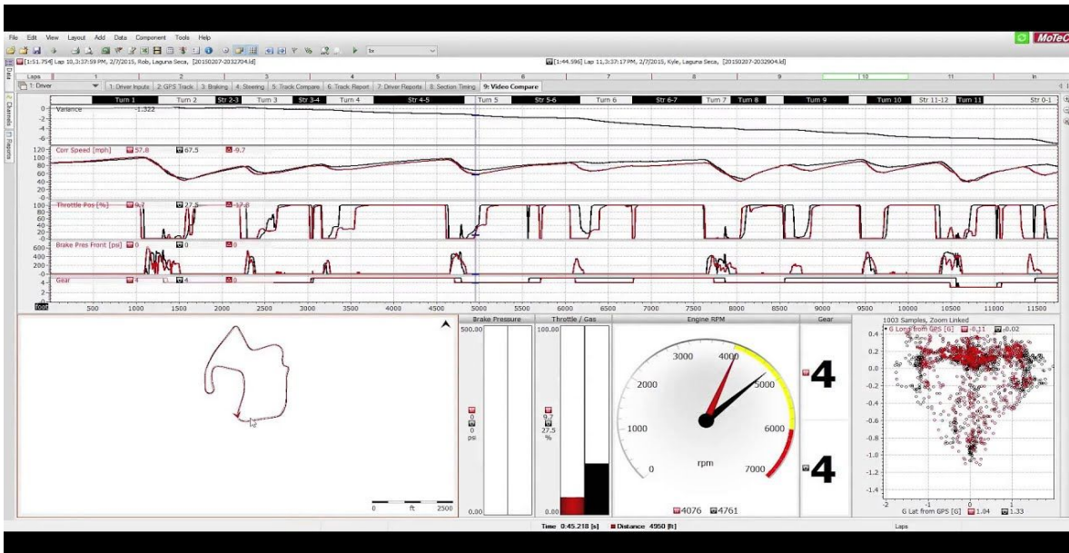
Rys. 2 Wykresy prędkości, biegów, położenia pedałów, które które umożliwiają analizę i poprawę zachowania kierowcy i ustawień bolidu
