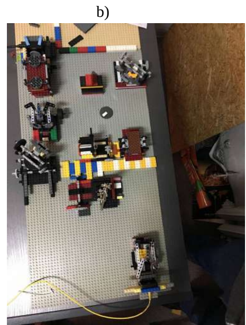
Rys. 2: a) – schemat układu CMH: 1 – laser He-Ne, 2 – światłowód sprzęgnięty z wyjściem lasera, 3 – soczewka kolimująca, 4 – światłodzielenie, 5 – zwierciadła płaskie, 6 – polaryzator, 7 – obiektyw mikroskopowy, 8 – soczewka kolimująca wiązkę po obiektywie, 9 – światłodzielenie sprzęgające wiązki, 10 – kamera CCD, 11 – hardware zbierający dane z kamery; b) - Realizacja układu CMH zbudowana przez Studencki Oddział SPIE
