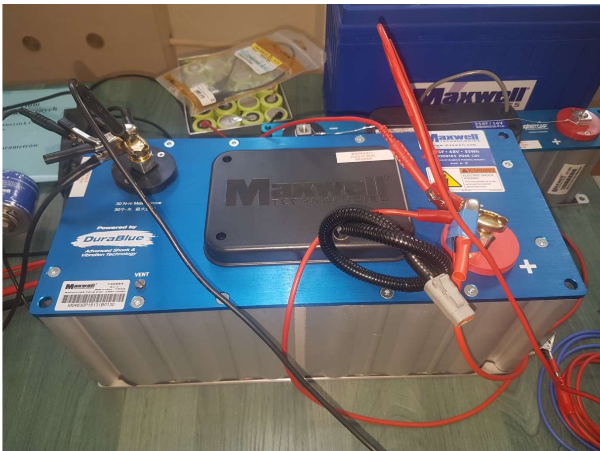
Rysunek 2. Główny element zasobnika – superkondensator w laboratorium SiMR PW
