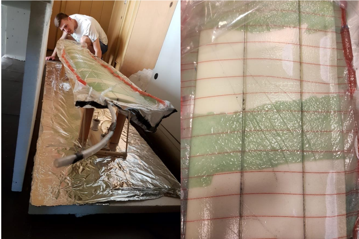
Rysunek 2 Łopata przed wygrzewaniem oraz powierzchnia łopaty zamkniętej w worku próżniowym
