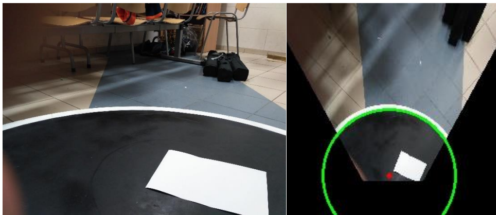
Figure 5 Rozpoznanie pozycji na ringu dzięki transformacji obrazu widzianego z perspektywy robota
