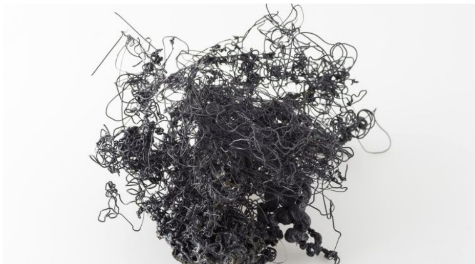
Przykład wydruku, gdy wydruk oderwie się od stołu na skutek niedostatecznej kontroli temperatury
