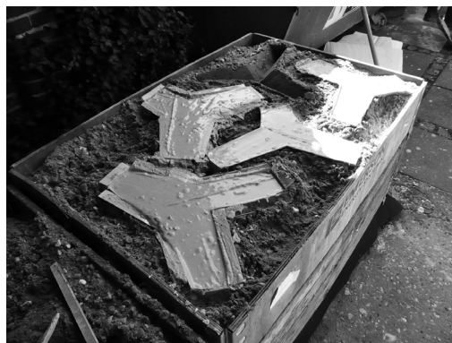
po lewej: ostateczna forma żelbetowa, po prawej: plastikowa forma odlewnicza
