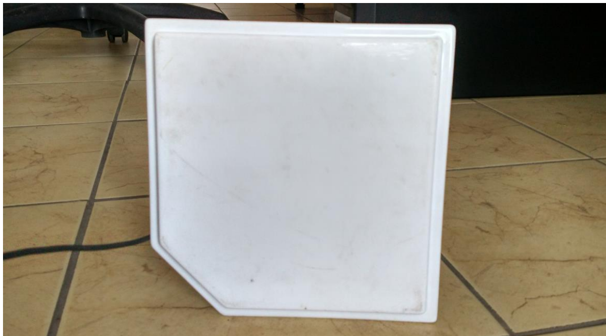
Rys. 2 Antena Gigaeter 18E umieszczona w plastikowej obudowie
